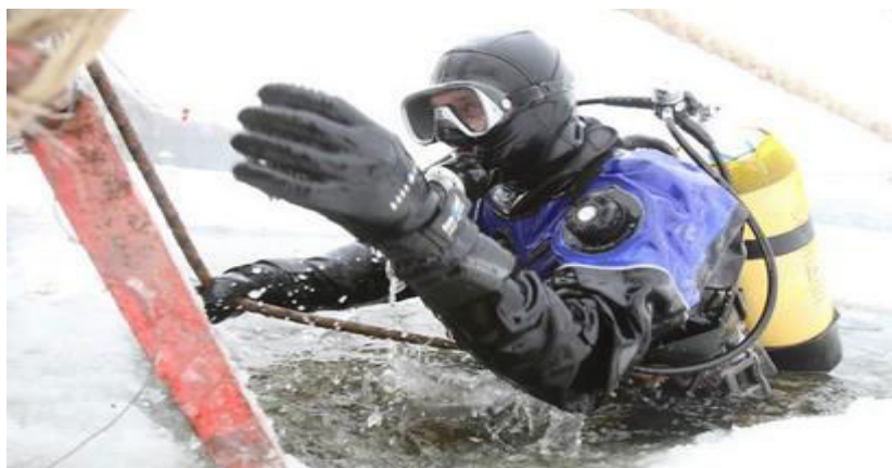
Рис. 3.1. Снаряжение с открытой схемой дыхания.
