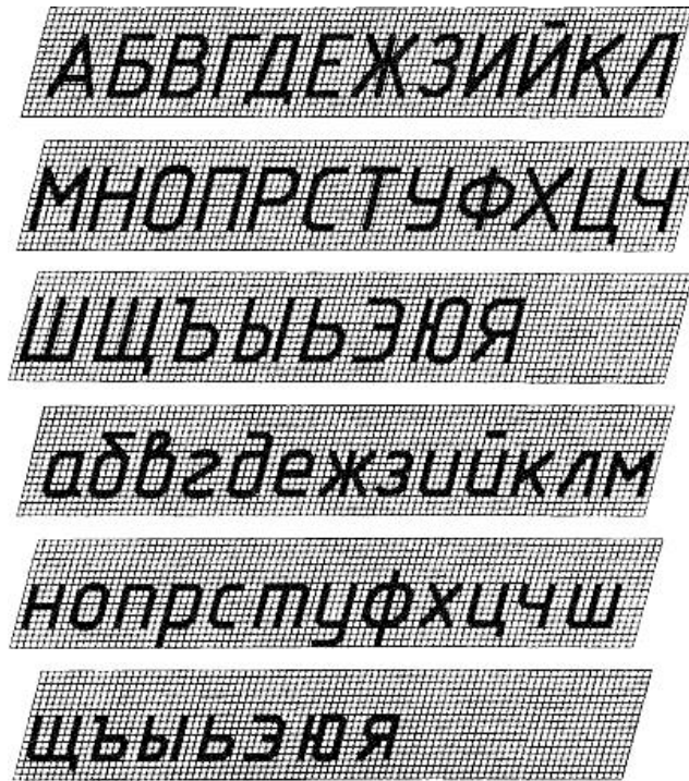
Рисунок 4.4 – Шрифт типа Б с наклоном
